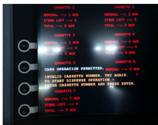
FIGURE 4.7 – Portée dérobée installée sur distributeur de billets - source : [42]
