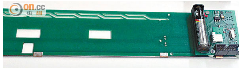
FIGURE 4.8 – Dispositif inséré dans le distributeur de billet afin d'injecter un virus - source : http://orientaldaily.on.cc
