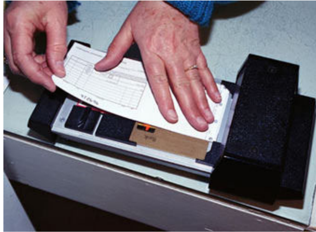
FIGURE 2.2 – Lecteur (sabot ou fer à repasser) d’embossage de carte de paiement - source : fortune.com
