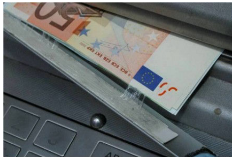
FIGURE 4.11 – Cash trapping à la réglette - source : Lyon Mag
