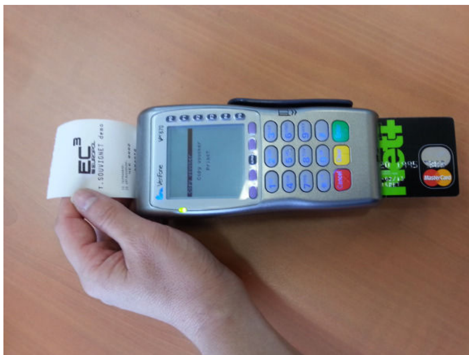
FIGURE 4.10 – Ticket client personnalisé imprimé par un TPE reprogrammé
