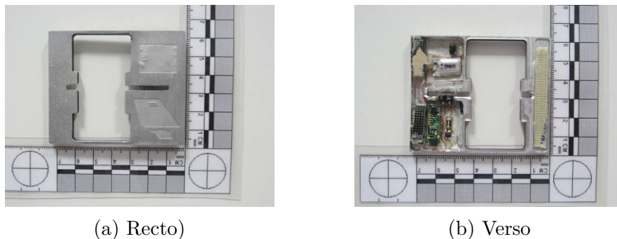
FIGURE 5.5 – Mouchard présent sur distributeur de carburant
